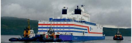
Baubeginn: 2007, Inbetriebnahme: 2020, kein eigener Antrieb, Gesamtleistung 70 MW (2 x KLT-405), extrem teuer – der Strom kostet ca. das 90-fache
